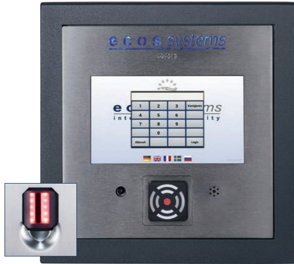
Terminal ecos 7", utilisé comme système d'accès et d'intercom avec RFID ou lecteur d'empreintes digitales
